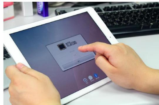
電阻式螢幕透過外力按壓，使上下層電極接觸，造成電壓變化而輸出指令。
